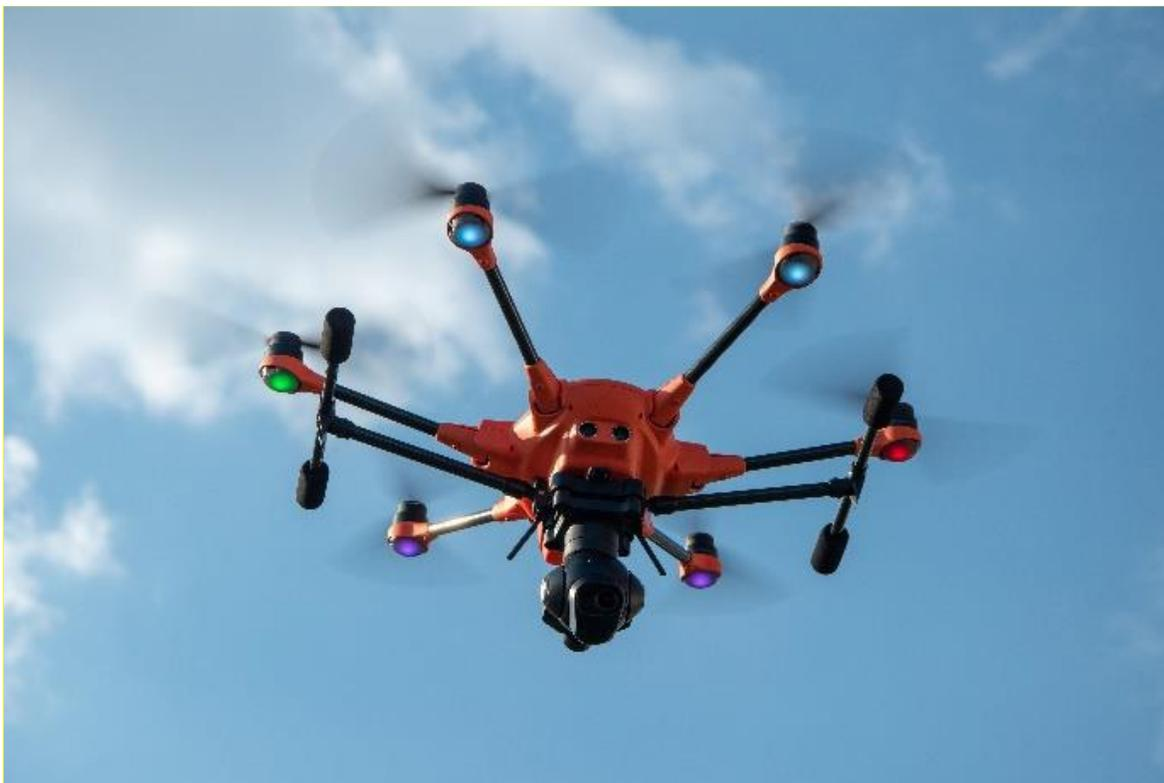
*Fig. 5. Drone carregando câmera termográfica*
